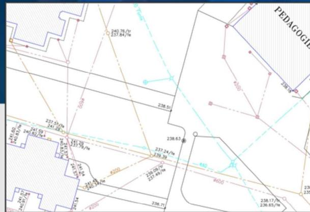
Relevé de regards et de canalisations (tracés, fils d'eau, diamètre, radier, etc...)
